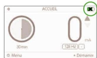
Figura 41. Indicatore di errore di carica della batteria
