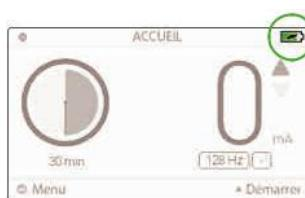
Figura 40. Indicatore di carica della batteria
